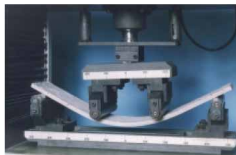
图 4 ECC 弯曲性能试验，像金属一样变形
