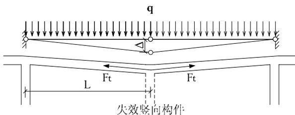
图 1 柱子失效后梁的跨越能力
