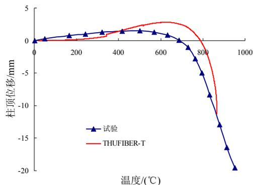
图 2 压弯柱计算结果和试验结果比较
