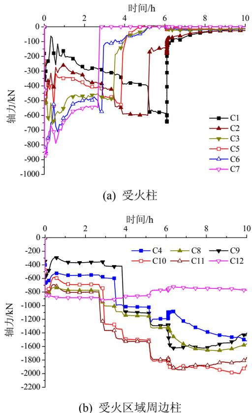
图 10 带楼板框架模型的柱轴力
