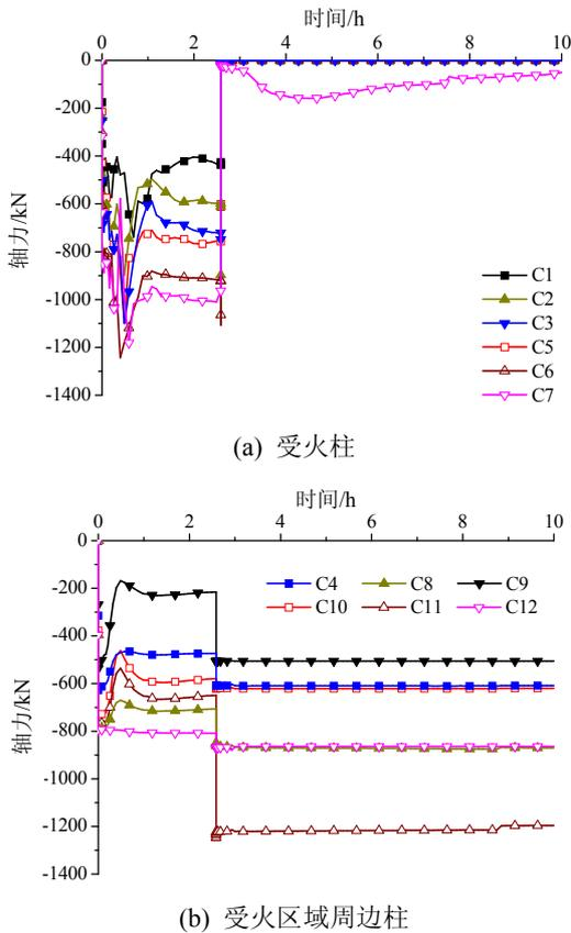
图 8 纯框架模型的柱轴力
