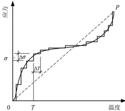
图 1 温度-应力路径的近似离散
