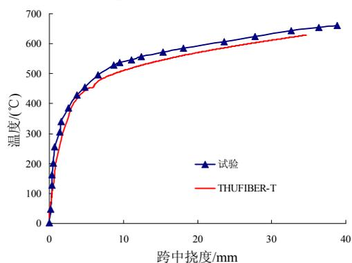
图 3 纯弯梁计算结果和试验结果比较
