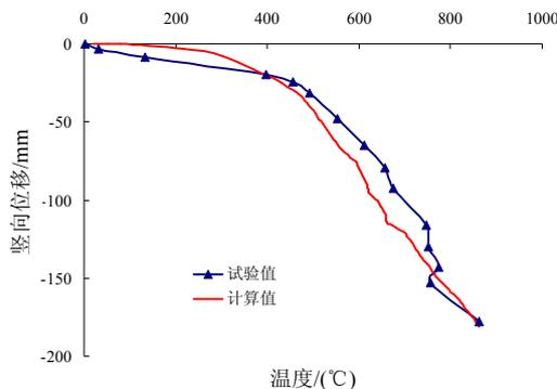
图 4 单向板计算结果和试验结果比较
