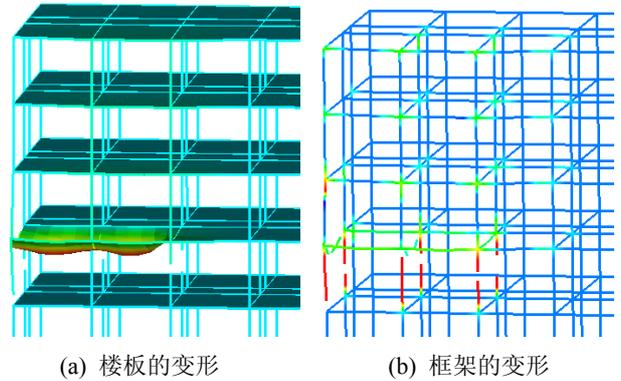
图 9 带楼板框架模型的模拟结果(t=6h, 变形显示比例 1:1)
